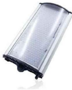
Ce luminaire, conçu et fabriqué en France, offre un flux de 23 000 lm. IP52, il est disponible en plusieurs versions, températures de couleur (4 000 K, 5 000 K, 3 000 K en option), alimentations, systèmes de variation et de pilotage Radio (0-10V, PWM ou DALI). Équipé de capteurs intégrés (présence ou/et luminosité) fonctionnant avec SiteWorx de Digital Lumens et l'Intelligence Smart Facility Mist, il économise jusqu'à 95 % d'énergie. 150 000 heures.
